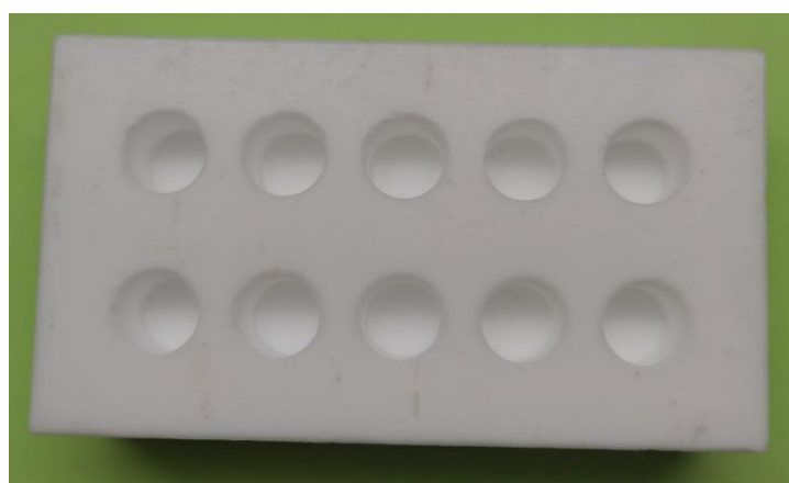
图 2.4 聚四氟乙烯复合支架制备模具, 为圆柱体模具, 直径 1 cm, 深度 1 cm
