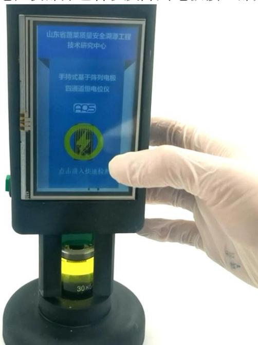
图 4.9 研制的基于阵列电极的便携式检测仪
