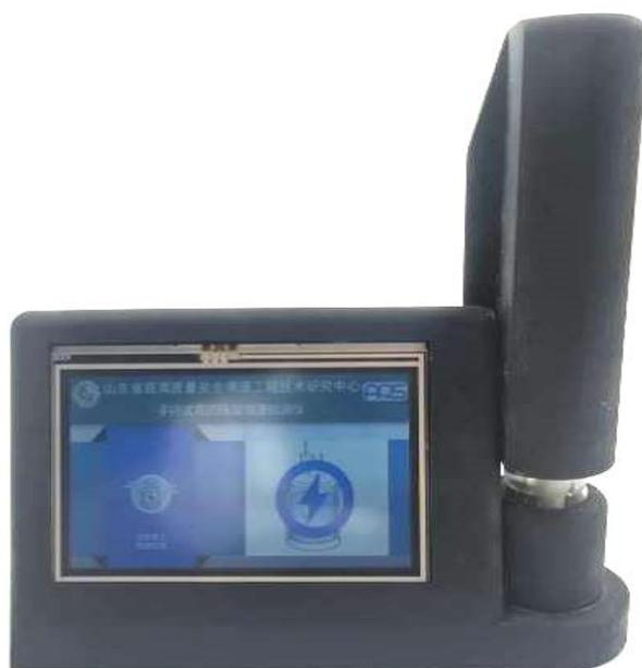
图 3.13 研制的基于三电极系统的便携式单路恒电位仪
