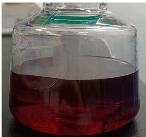
图 29 制备完成的胶体金溶液
